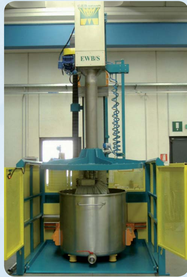
EWB/S - impianto per il lavaggio a solvente con doppio sistema spazzole/testina.
