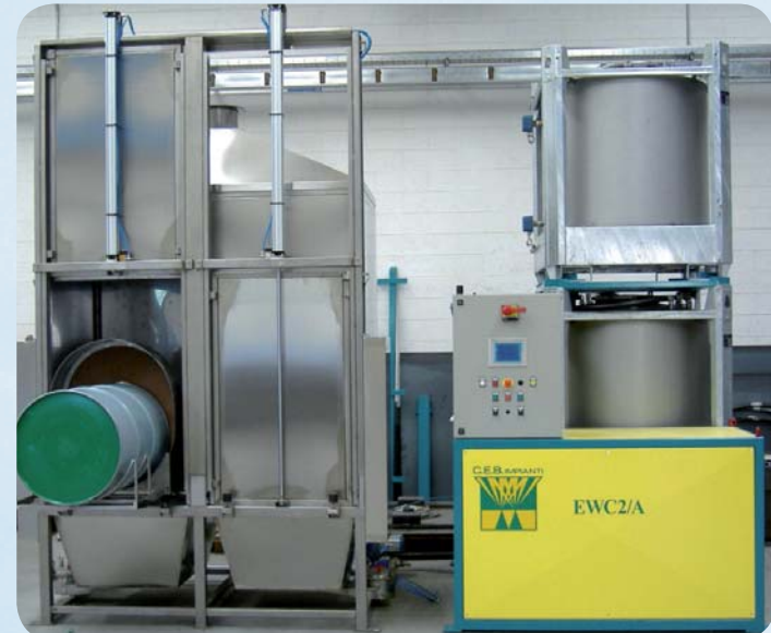
EWC - impianto (ad acqua o a solvente) per il lavaggio interno di fusti aperti e a tappo da 2" disponibile con postazione singola e con postazione doppia.
