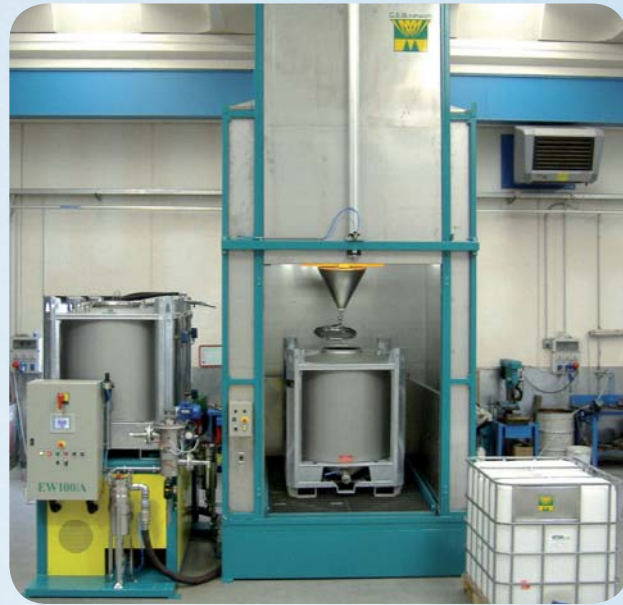
EW100 - impianto (ad acqua o a solvente) realizzato in cabina di contenimento con vasca raccolta reflui.
