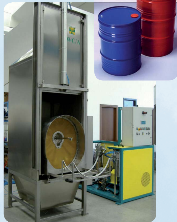
EW100KAB - impianto (ad acqua o a solvente) per il lavaggio interno di contenitori troncoconici.
