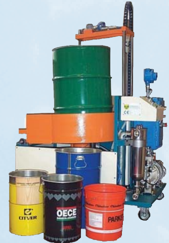
EW/ES - macchina per il lavaggio di contenitori a totale apertura o con tappo da 2".
