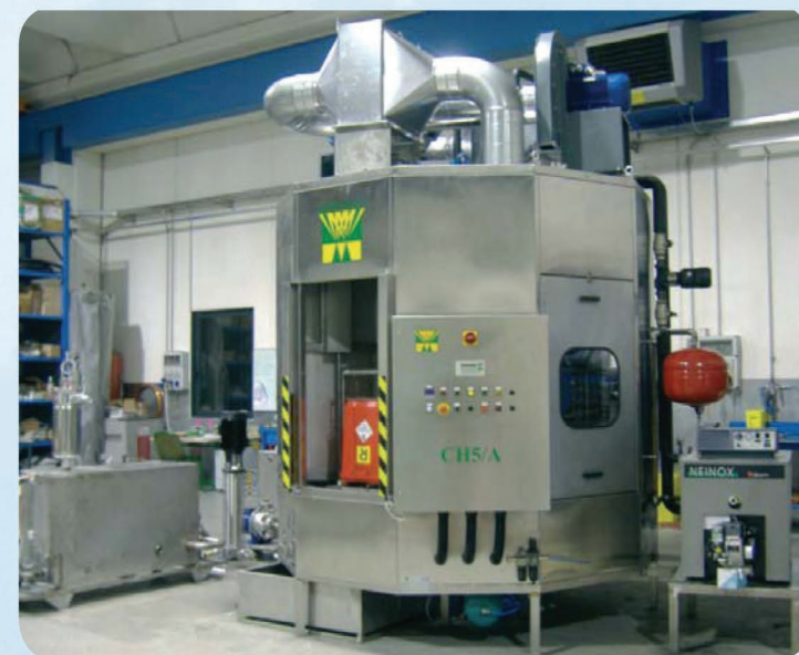
CH5/A - impianto in acciaio inox automatico per il trattamento di piccoli contenitori (lavaggio interno, lavaggio esterno ed asciugatura).
