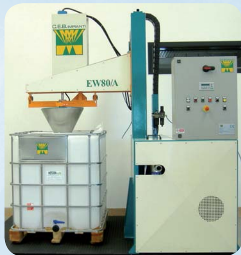
EW80/A - macchina per il lavaggio interno ad acqua di cisternette palettizzate e vasche aperte.
