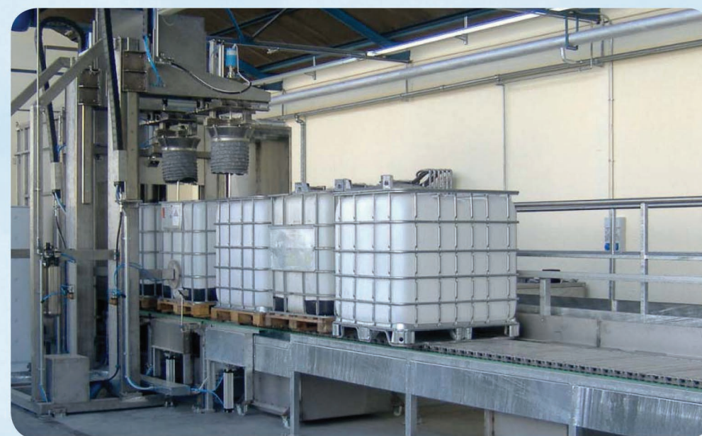
EW1000/A: Linea automatica per il lavaggio interno ed esterno, asciugatura e test di controllo di IBC.
