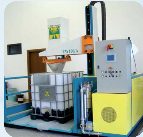
EW100D/S - macchina a doppia postazione per il lavaggio interno a solvente di cisternette palettizzate e vasche aperte.
